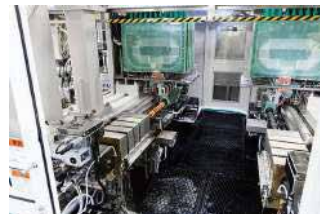
富士電子工業が手がける製品例 写真左:カムシャフト焼入機 写真右:クランクシャフト(製造品) ※部品の場合によって、焼入の温度(硬度)を細かく調整できるのが特長
