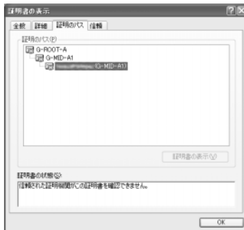
図14 中間証明機関に相互認証証明書をインポートしないと、パス構築に失敗する
