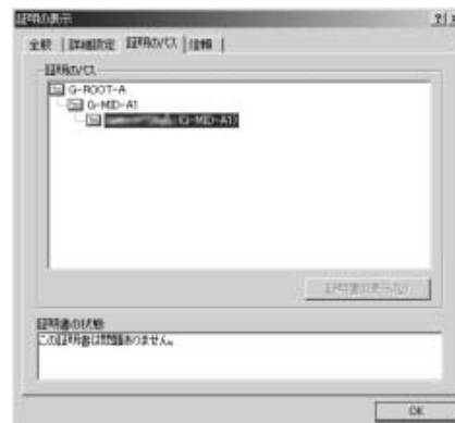
図8 従属階層型信頼モデルでの署名検証（左）と、証明のパス（右）
